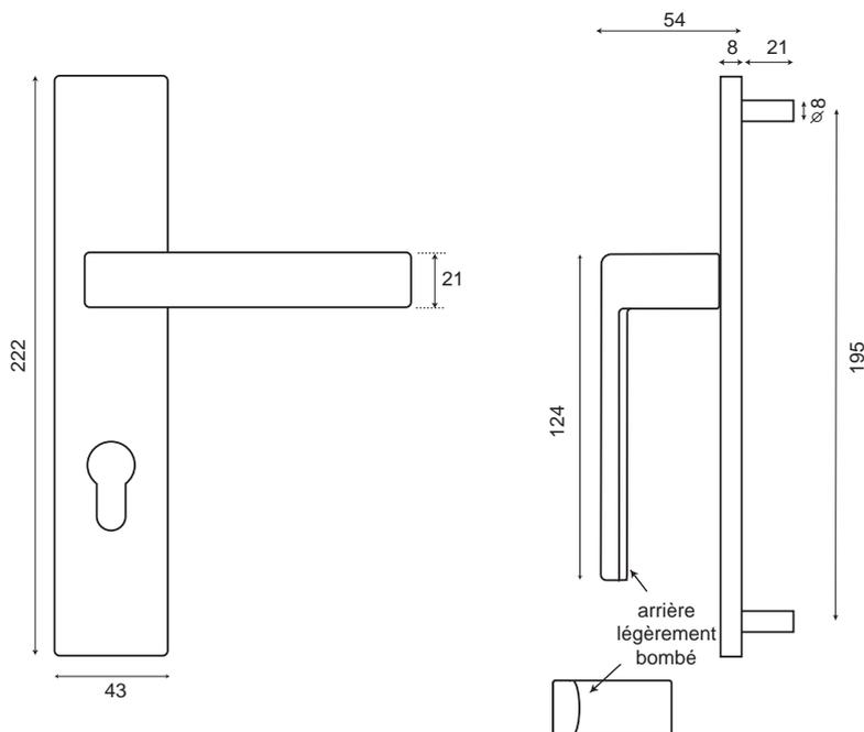
Ensemble sur plaque rectangulaire en aluminium anodisé aspect inox pour portes intérieures, composé d'une béquille sans ressort de rappel sur plaque avec sous-construction en nylon et piliers de soutien pour plus de robustesse.
