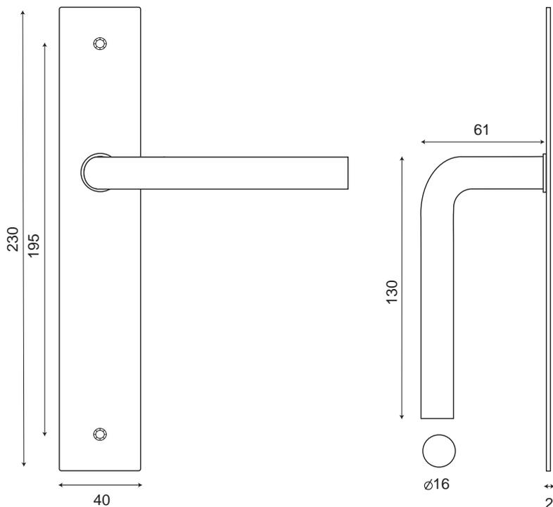
Poignée tubulaire coudée, à section ronde fine diamètre 16mm, montée sans ressort de rappel sur grande plaque rectangulaire fine de 2mm, 4 fonctions.
