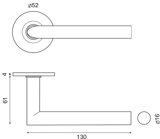
Poignée tubulaire en angle droit, à section ronde fine diamètre 16mm, montée sans ressort de rappel sur rosace ronde fine de 4mm. Sous-rosace et portée en inox
