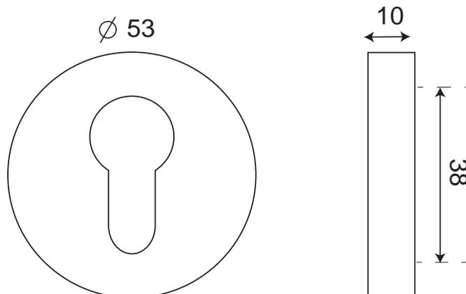
Rosaces de fonction composées d'un enjoliveur à clipser sur sous-construction en nylon
