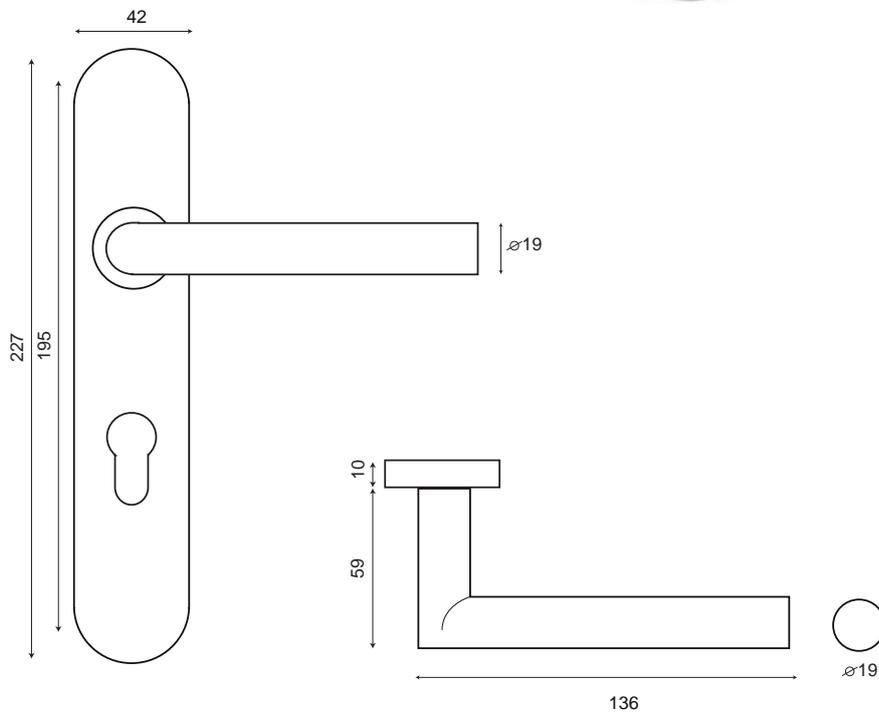
Poignée tubulaire en angle droit sur grande plaque aux extrémités arrondies pour portes de 40 / jusqu'à 50mm en Cylindre
